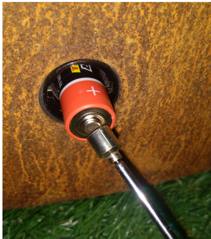
Zdjęcie 6: Wyciąganie pierwszej baterii za pomocą magnetycznego chwytaka
