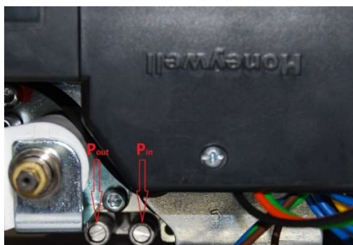
Zdjęcie 3 - Króćce pomiaru ciśnienia gazu
