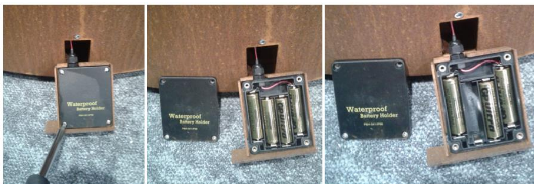
Fot. 7 – Wymiana baterii
