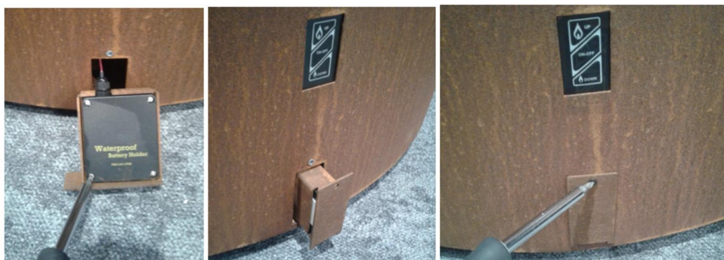
Fot. 7 – Wymiana baterii
